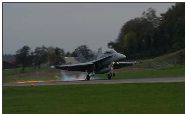
Abb. 4 Landung einer F/A-18 mit dem Fanghaken für eine sehr kurze Landestrecke (LW)
