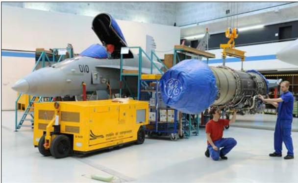
Abb. 2 Wechsel eines Triebwerks einer F/A-18 (RUAG)
