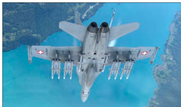
Abb. 8 F/A-18 in voller Bewaffnung mit 10 AIM 120 AMRAAM und 2 AIM 9X Sidewinder (LW)
